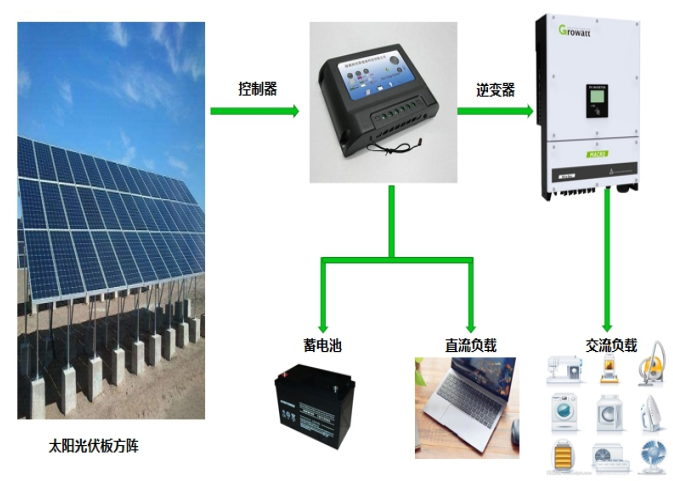
A.离网系统工作原理图
